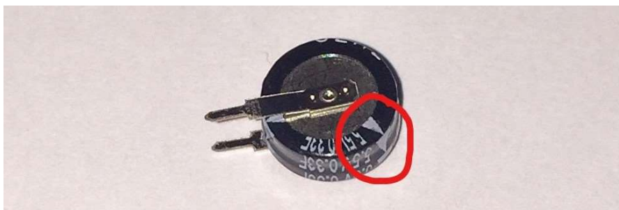
Abbildung 2: Polarität am Gold Cap erkennen
